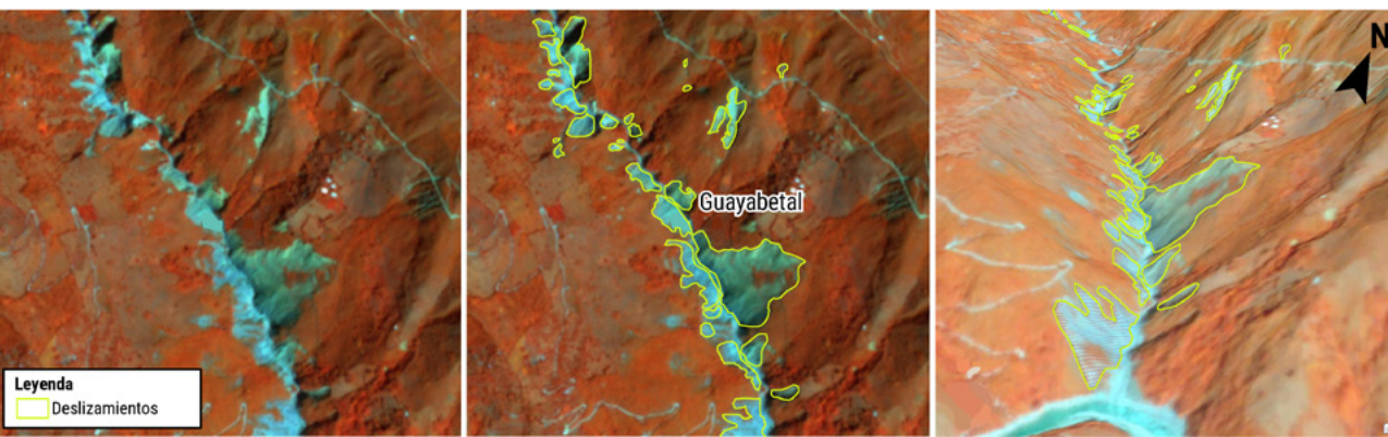
Figura 3 - Imágenes municipio Guayabetal, a) imagen zonas de deslizamientos, b) polígonos de deslizamientos capturados, c) vista 3D de las zonas deslizadas en ArcGIS Pro
